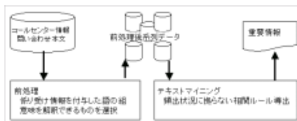
図1 コールセンター情報を対象にした重要情報発見のフレームワーク
