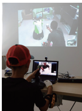
図 2: (左写真) の子どもはロボット (右写真) を遠隔操作しながら外国人教師の英会話レッスンに参加している。子どもは左手のジョイスティックでロボットの移動を制御しながら、右手に着用したデータグローブを用いて把持を制御している。まだ英語を使えない子ども達でも物体把持や身体動作を通じて外国人教師とコミュニケーションをとることが可能で、リラックスしてレッスンに参加することができる。
