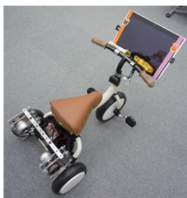
図 1: 主に 3~5 歳の子どものために設計・開発された三輪車型のロボット操作インターフェース。
