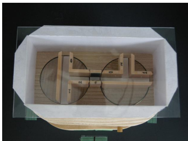
図 2 ターンテーブル式迷路装置
