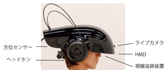
図1. 体験ユニット. モニター部: SONY 社製 HMZ シリーズに準拠. 前部カメラ: IDS 社製 USB ボードカメラ LE4021. そのほか方位センサー、ヘッドホン、視線計測装置を内蔵。
